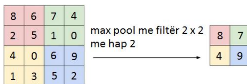
Figura 3.13. Pooling sipas vlerës maksimale për një filtër me përmasa 2 \times 2 , me hap 2. Përshtatura nga [36]. Çdo veprim i pooling përzgjedh vlerën maksimale midis 4 vlerave të dritares së filtrit ( 2 \times 2 ) duke eliminuar 75% të vlerave të tjera.
