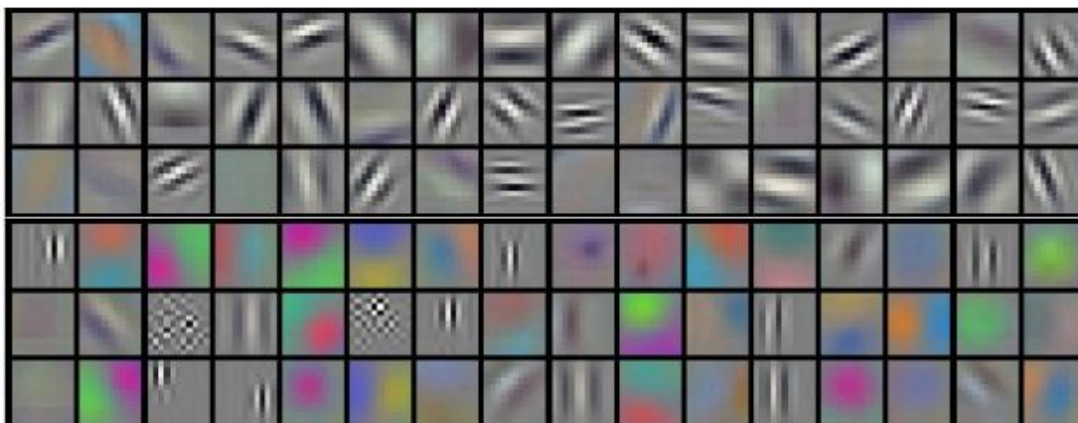
Figura 3.10. Filtrat e mësuar nga një rrjet CNN [51]. Secili nga 96 filtrat ka dimensionin 11 \times 11 \times 3 . Këto filtra përdoren nga secili prej 55 \times 55 neuroneve përgjatë dimensionit të thellësisë.
