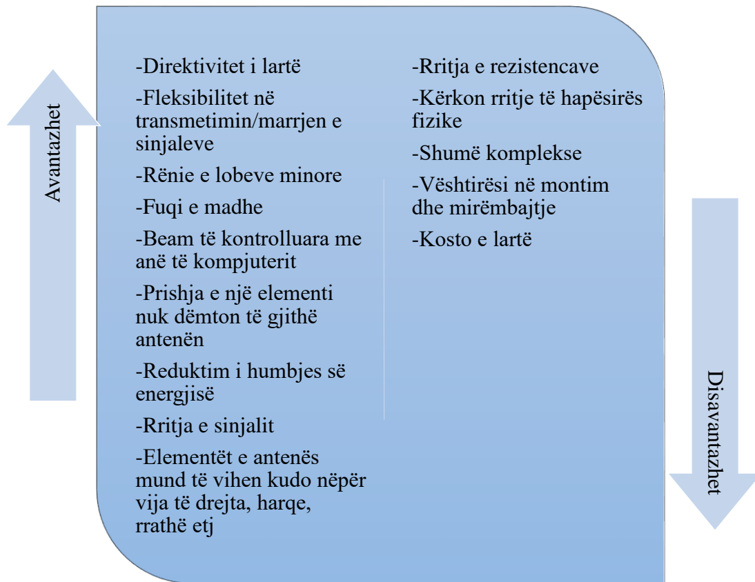
Fig. 2.2 Avantazhet dhe disavantazhet e antenave array
