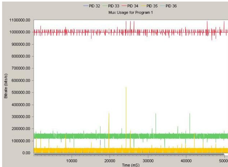
Figura 6.16. Shfrytëzueshmëria e gjerësisë së brezit-një kanal IPTV
