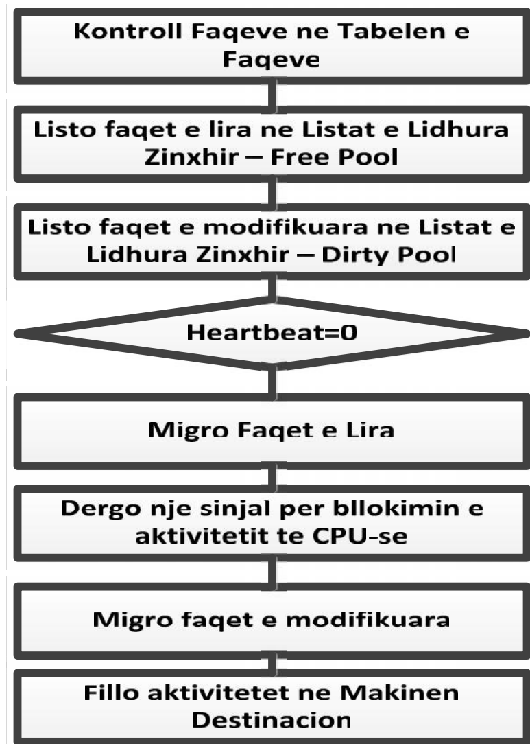
Figura 6.11-Algorithmi i teknikes Cold Migration midis Hypervisoreve te ndryshem duke implementuar formen me lista te lidhura zinxhir.
